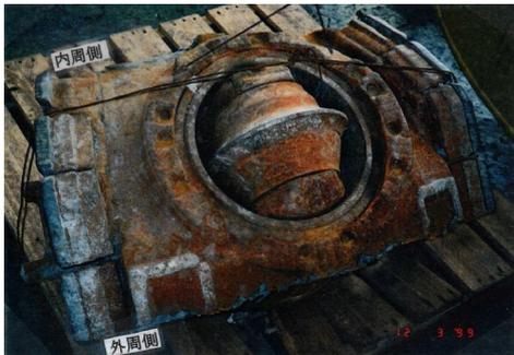
写真 - 2 掘進完了後ディスクカッター状況
