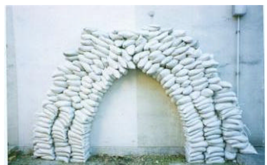
図 - 6 実際の「土のう」を積み上げたアーチ
