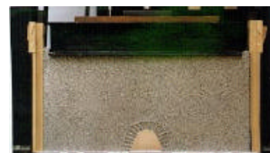
図-1 「土のう」アーチ模型実験
