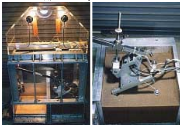
写真1 実験容器に装填した模型クレーン(左)及びアウトリガーが地盤にめり込んで転倒した模型の様子(右)
