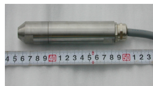
図4 埋設したA Eセンサー
