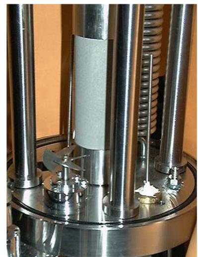
図1 三軸セル内部の写真
