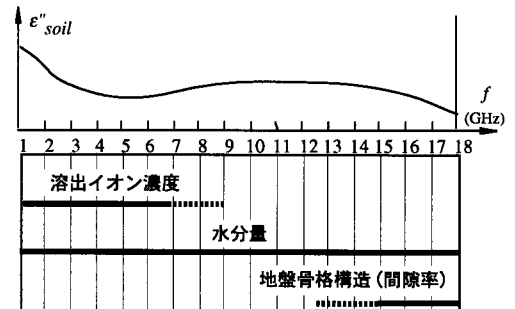
図-6 誘電損率の周波数特性と地盤構造。
