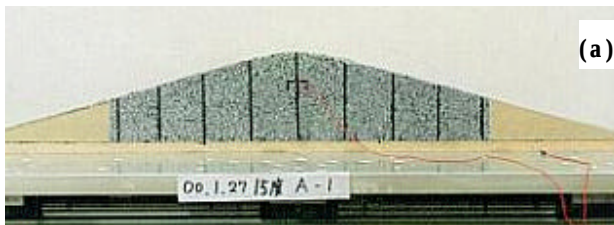
写真-3 両端擁壁補強：(a) 振動前、(b)崩壊時
