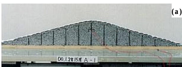
写真-5 紙製「土のう」による表層補強：(a) 振動前、(b)崩壊時
