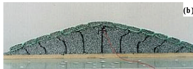
写真-4 ポリエチレン製「土のう」による表層補強：(a) 振動前、(b)崩壊時
