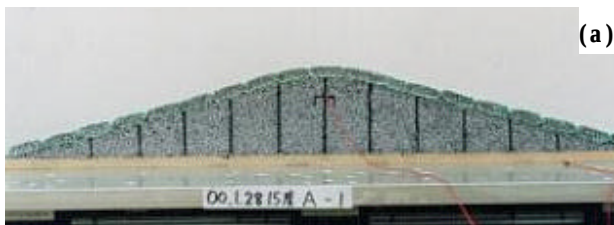
写真-4 ポリエチレン製「土のう」による表層補強：(a) 振動前、(b)崩壊時
