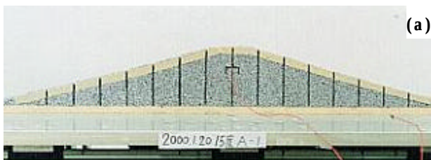
写真-2 ガムテープによる表層補強：(a) 振動前、(b)崩壊時
