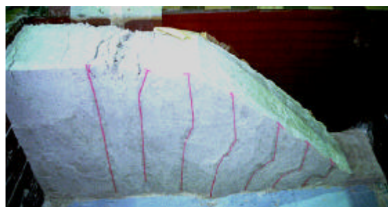
(a) FEM による解析結果（残留変形とせん断ひずみ分布） (b) 遠心実験結果（実験後の写真）
