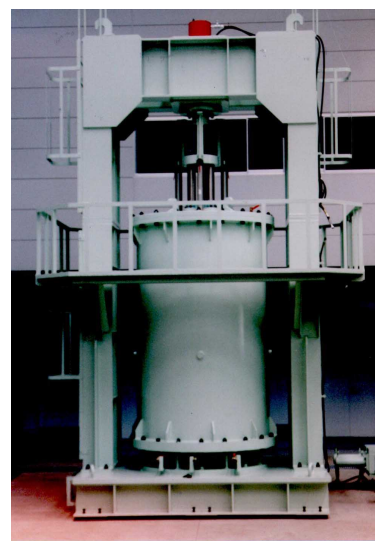
写真-1 超大型三軸圧縮試験機全景
