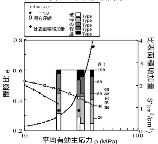
図-5 異方、等方圧縮試験結果
