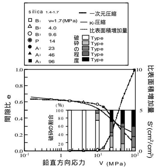
図-1  $K_0$  及び一次元圧縮試験結果
