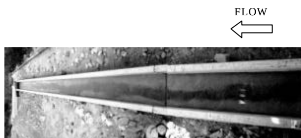
写真2 12時間後の底面の侵食
