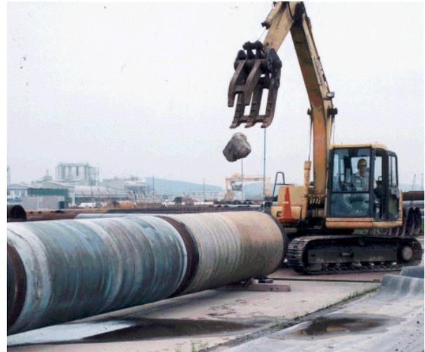
写真1 落石試験
