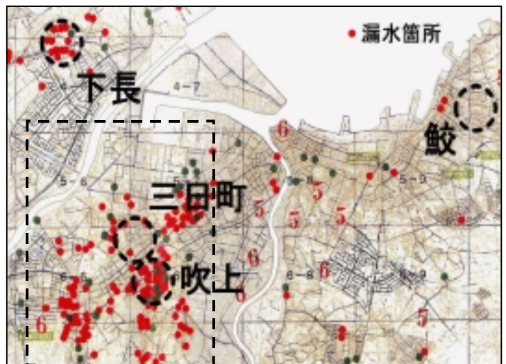
図-1 道路漏水箇所
