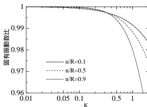
図 - 5 単純支持梁における固有振動数比 (縦軸:  $\sqrt[4]{K_D/K_C}$ )
