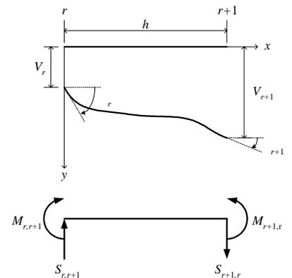
図 - 2 変形、断面力の正の向き
