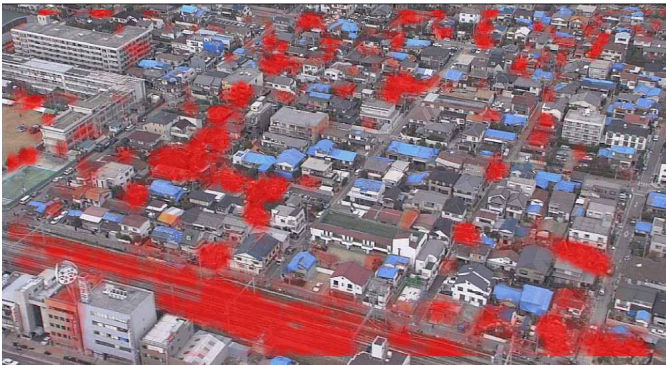
図-5 画像解析による被害建物の抽出結果（地域 B）
