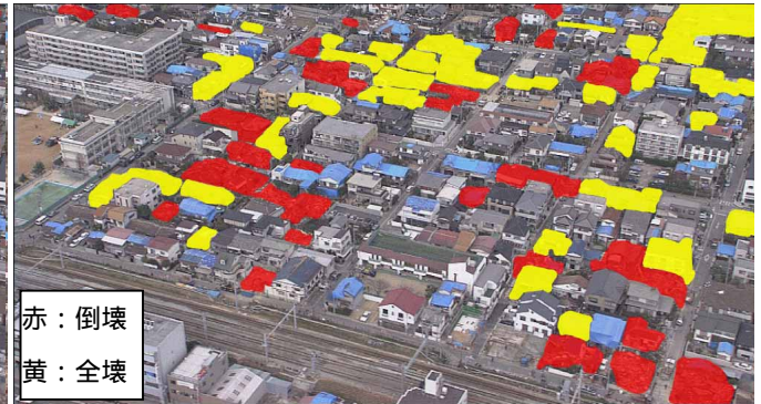
図-6 建物被害地上調査データ、空撮画像目視判読に基づく被害建物の分布（地域 B）
