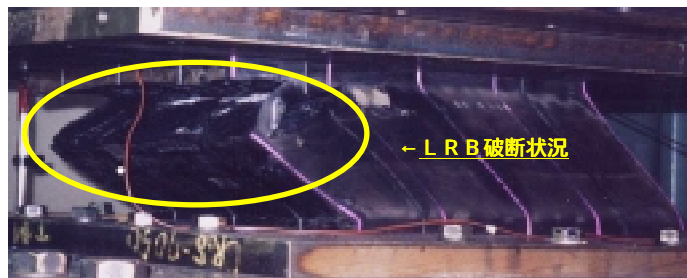
写真 - 2 LRB 破断状況
