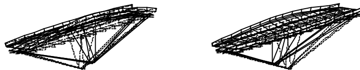
図2 かさこ谷川橋の振動モード(実測値)
