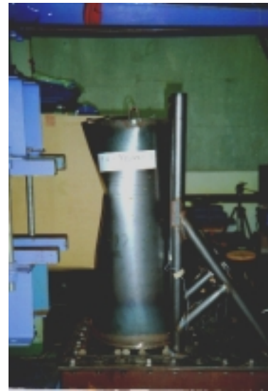
写真-1 鋼製セルの変形状況
