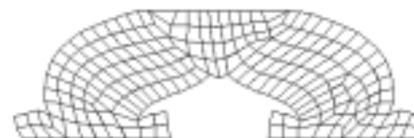
図-4 大変形考慮の場合の変形状況(35%ひずみ時)
