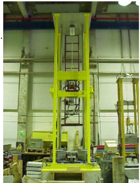
写真 - 1 大型衝撃実験装置
