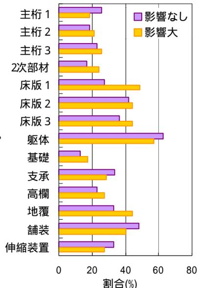
図2 最大積雪深と部材損傷の関係
