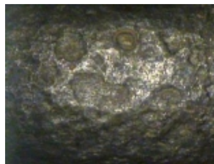
図 - 2 腐食区間外観 (0.5 \sigma_y 100cycles)
