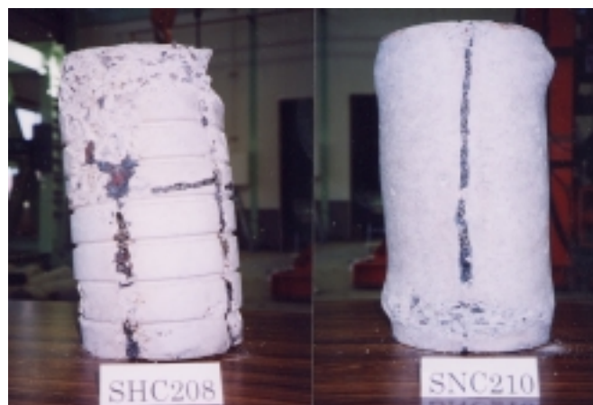
写真 - 1 内部破壊状
