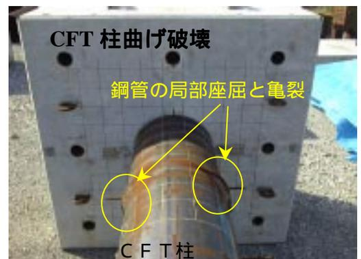
写真1 実験後試験体状況 (JTSC-2)
