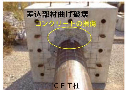
写真2 実験後試験体状況 (JTSC-9)
