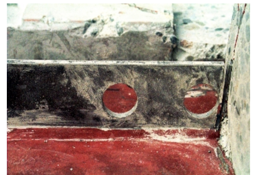
写真-1 破壊状況(鉄筋なし，板厚 8mm)
