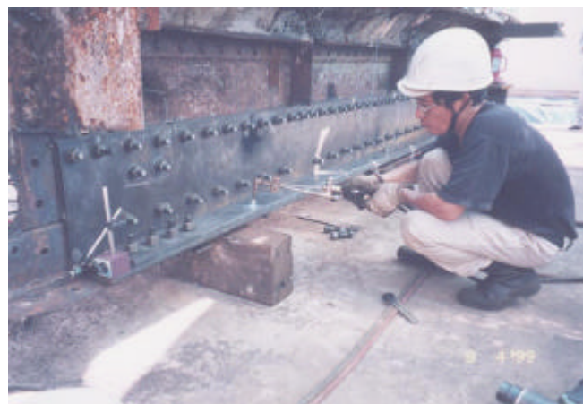
写真-1 熱プレストレスを与える実験状況
