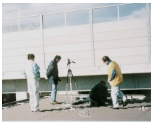
写真—1 鉄道高架橋での振動測定
