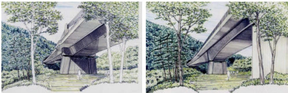
図-3 エクストラードード橋(左)とPC箱桁(右)の中間支点部形状の比較
