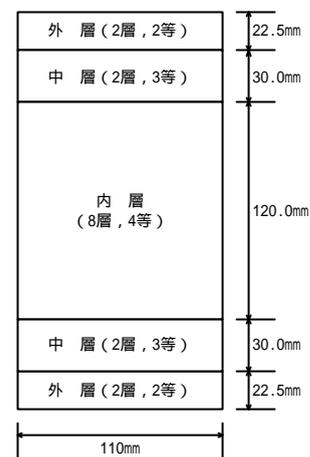
図-1 曲げ試験体の積層構成図
