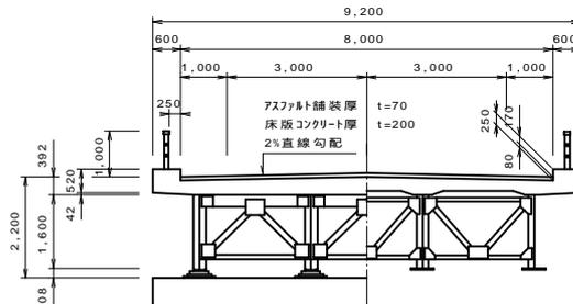
図-2. 有根橋の断面
