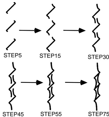
図-1 圧縮応力下  $\sigma_y = -\sigma_0$  のクラック群の進展解析
