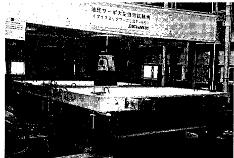
写真-1 定点高サイクル疲労試験状況
