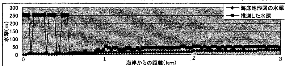
図-6 海底地形図推測水深パターンの比較 1988年 バンド2 2次回帰分析
