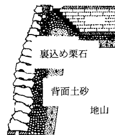
図－1 石垣断面模式図
