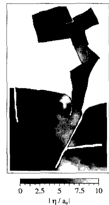
図-5 水面変動の増幅率分布（ T=100[\text{s}] ）
