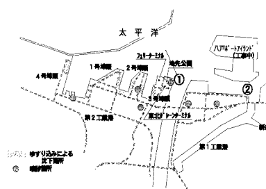
図-2 液状化の影響箇所
