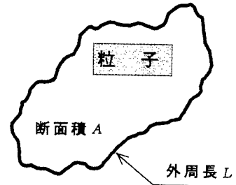
図-1 粒子の投影断面模式図
