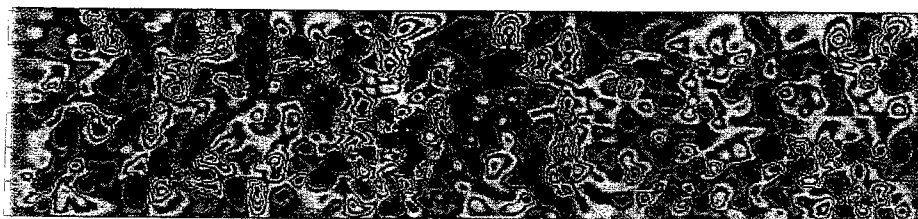
図-5 半径方向の瞬時速度せん断 ( dv/dx )
