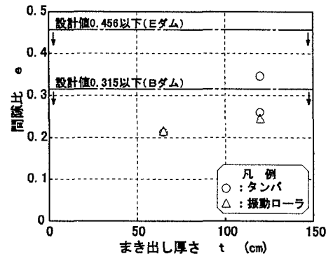
図－4 まき出し厚と間隙比 (Dmax30cm, φ200cm)
