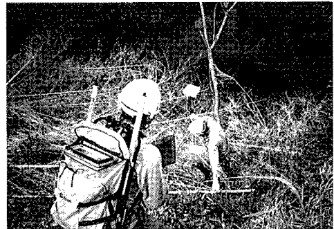
写真-1 RTK-GPS測量状況
