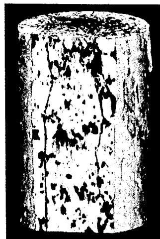
図2 琉球石灰岩の3次元画像 (1軸圧縮試験後の円柱試験片、直径19.3cm)
