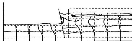
図2: 加振後の地盤の最終状態
