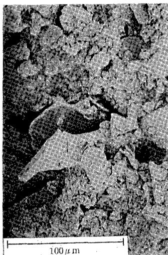
写真-3 高温再圧密粘土の水平断面
