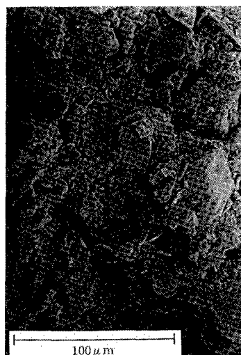
写真-4 高温再圧密粘土の鉛直断面
