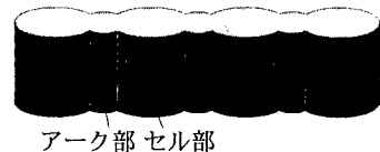
図 1 プレハブ鋼矢板セル模式図
