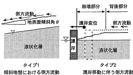
図1 側方流動量の発生パターン
