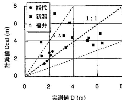
図4 側方流動量の実測値と計算値との比較
