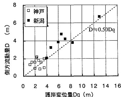
図6 護岸変位量と側方流動量の関係
