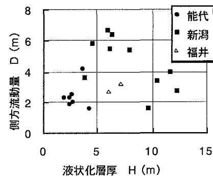
図2 液状化層厚と側方流動量の関係
