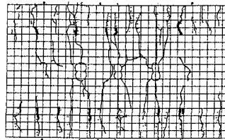
図4(a) 桁中心部のひび割れ PPO-1.0
