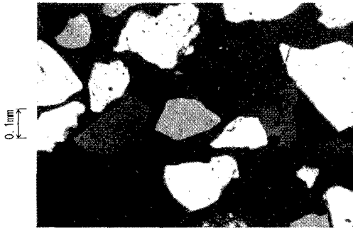
写真-1 豊浦砂のみ, Dr=65%の試料の顕微鏡写真
