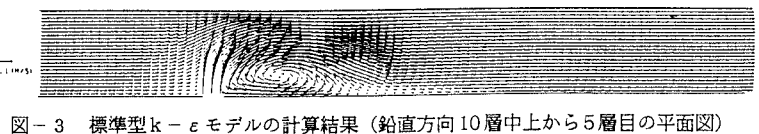
図-3 標準型 k-\varepsilon モデルの計算結果(鉛直方向10層中上から5層目の平面図)
