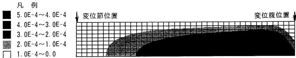
図-3 せん断ひずみ \gamma_{yz} 分布(地震動入射角 \theta_{in}=45 度)
