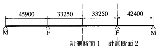
図1 計測区間のスパン割と計測断面の位置
